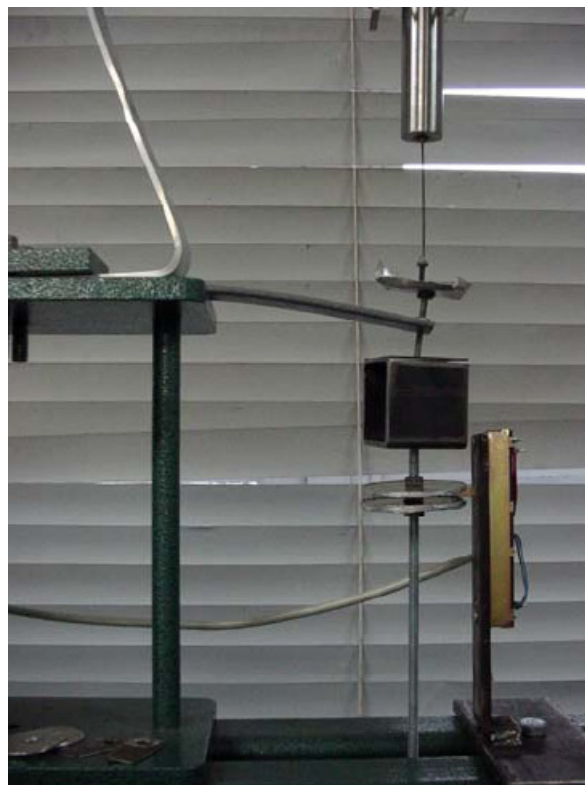
Figura AV. 2: Viga deformada
