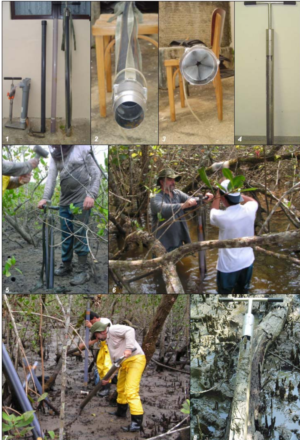
ANEXO A- 1. amostrador “Eijkelkamp”, com a bomba de sucção e os tubos de amostragem, sendo os tubos pretos para coleta para datação por termoluminescência (TL); 2 e 3. detalhes da ponteira do amostrador “Eijkelkamp”; destacando a membrana inflável a qual permite a coleta do solo saturado com água; 4. amostrador para solos inundados; 5 e 6. amostragem em campo com o amostrador “Eijkelkamp”, na figura 6, destaca-se a amostragem com o manguezal inundado; 7 e 8. amostragem com o amostrador para solos inundados
