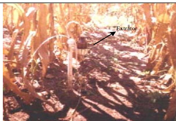
Figura 13 - Extrator de solução do solo
