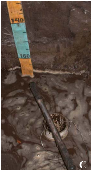
A – Exemplo de tradagem realizada na análise estrutural; B – Amostragem envolvendo o trado com o tudo de PVC evitando assim a queda de material arenoso no orifício da coleta; C – Mesmo esquema, no fundo da trincheira e D – Tronco caído encontrado na trincheira H3, datado em 1500 anos A.P.
