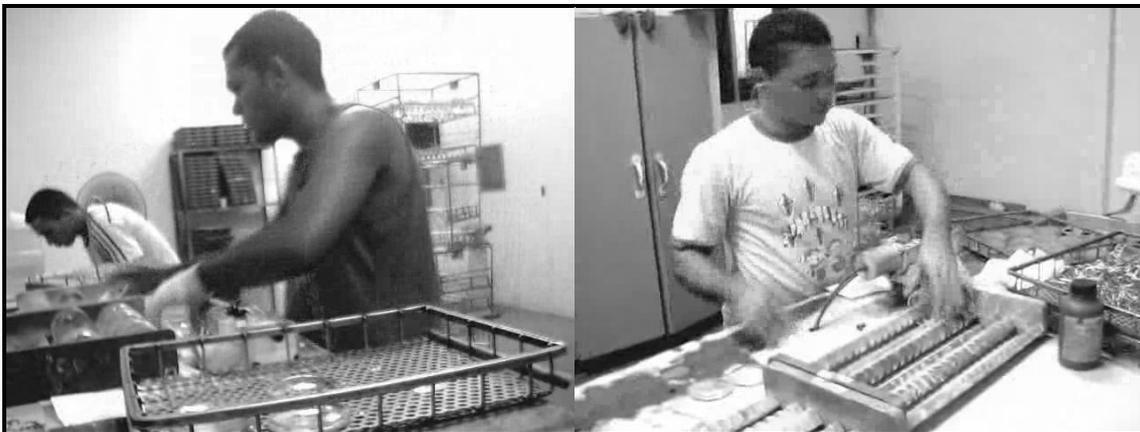
**Figura 13:** Operação 3 – “Colocação do molde e da lente em seus suportes”
