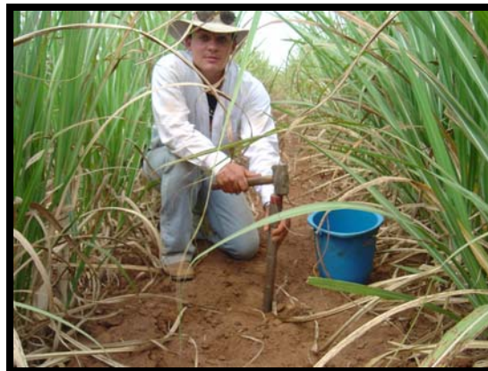
Figura 4 - Amostragem de solo na entrelinha de plantio, utilizando-se sonda
