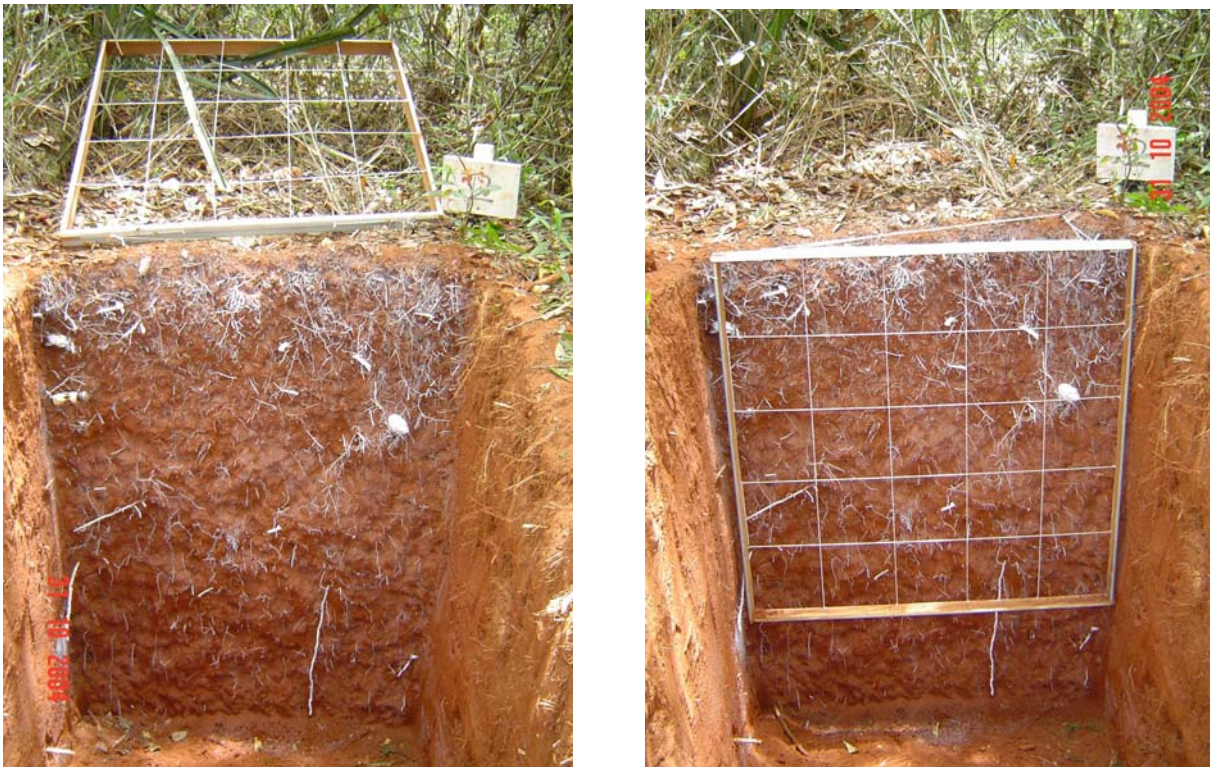
Figura 5 – Exposição das raízes e preparo dos perfis de solo para aquisição de fotografias digitais por quadrícula de 0,20 x 0,20 m
