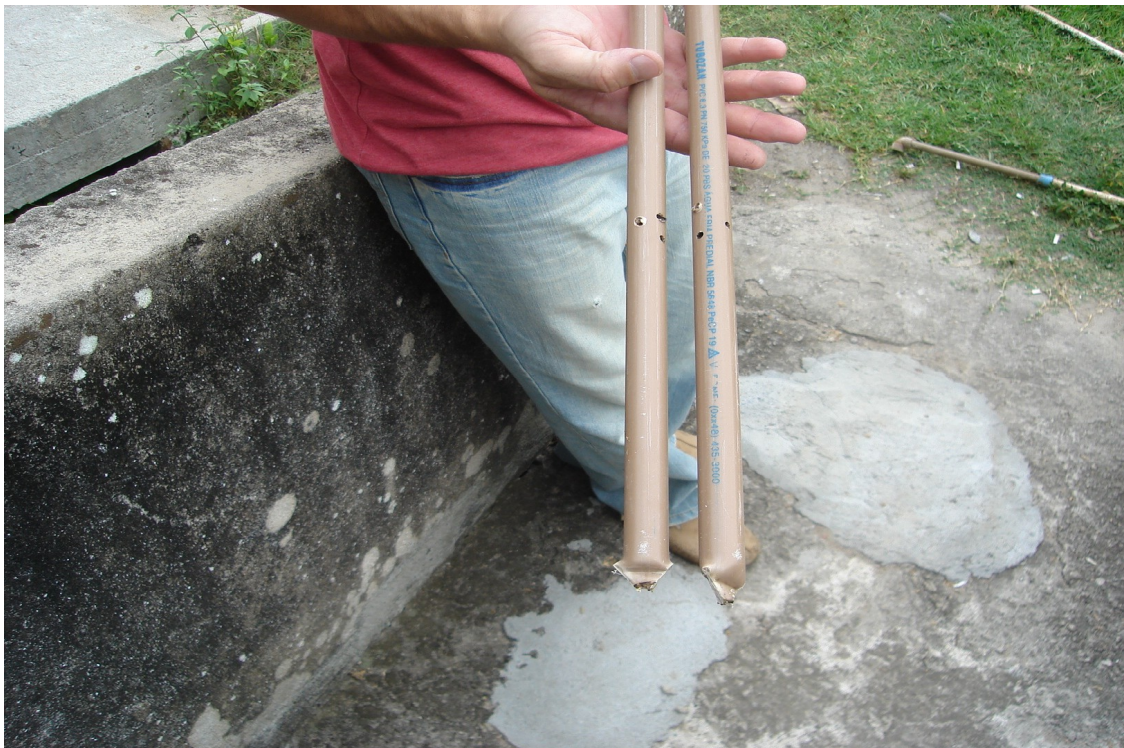
Figura 9 – Tubos de PVC fechados na extremidade e perfurados a 20cm de altura.
