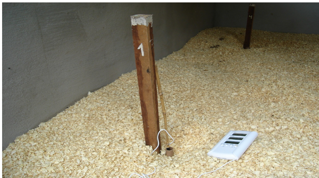
Figura 13 – Aferição da temperatura da biomassa no ponto 1.
