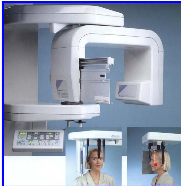
Figura 15 – Localização na face do paciente do Dosímetro TLD-100 para mensuração de dose de radiação ionizante absorvida (PLANMECA)
