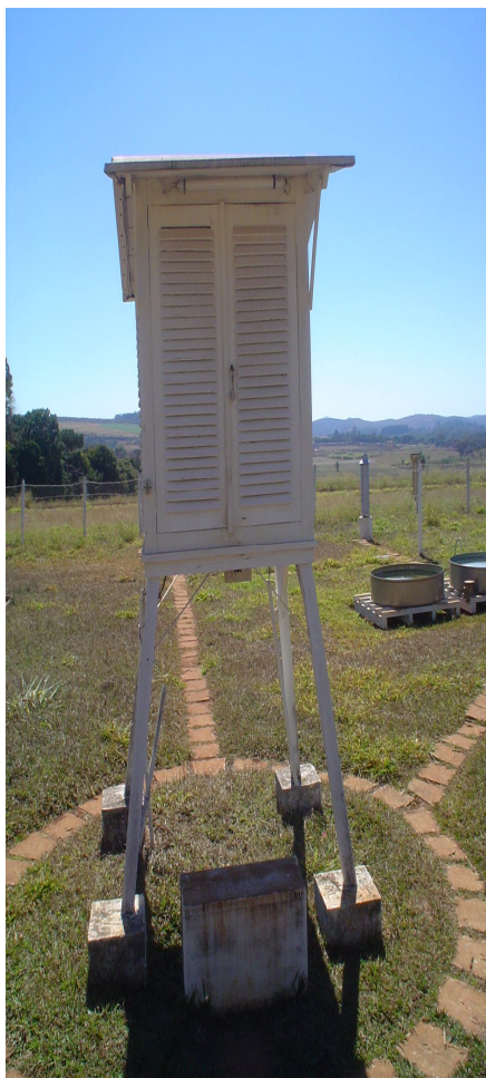
Foto 13: Abrigo meteorológico no CNPMS
