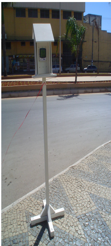
Foto 7: Abrigo meteorológico instalado na Praça da Rodoviária
