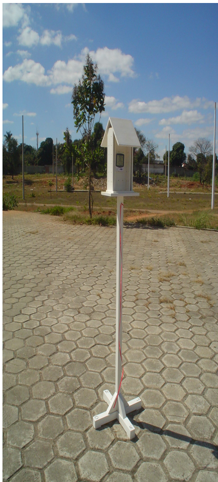
Foto 3: Abrigo meteorológico instalado na Avenida Antônio Olinto
