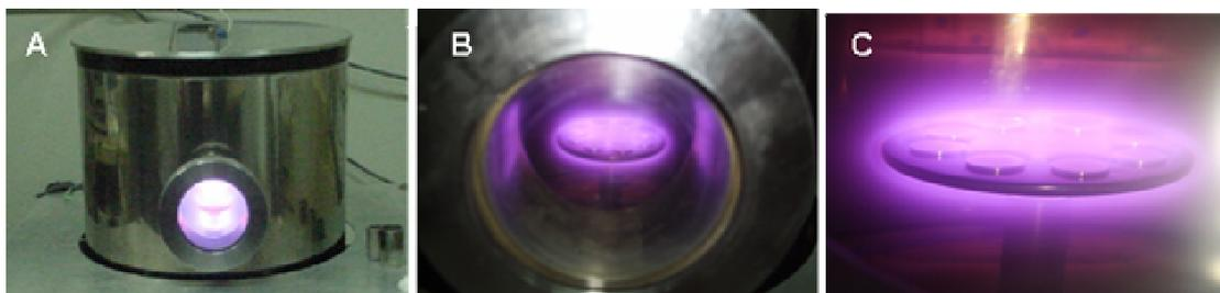
Figura 3 – Aparato experimental do Laboratório de Processamento de Matérias a plasma utilizado para tratamento das superfícies de Ti. A - Câmara hermeticamente fechada. B- Cátodo planar. C- Discos de Ti dispostos sobre o cátodo recebendo o tratamento
