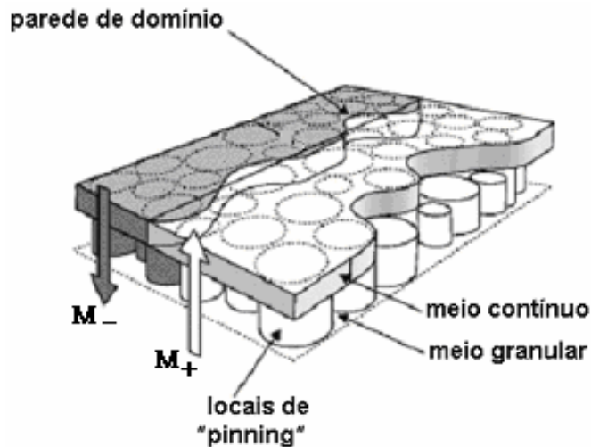
Figura 4 : Representação esquemática da formação de domínios em uma media granular do tipo CGC [9] .
