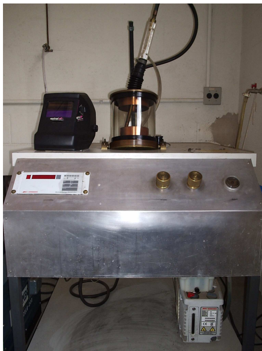
Figura 3.10: Forno de fusão a arco voltaico utilizado na preparação de ligas de cromo no Grupo de Supercondutividade e Magnetismo. O material a ser fundido é introduzido na câmara de vidro. Nesse espaço faz-se a purga do oxigênio com a inserção de argônio para evitar a oxidação da amostr. O circuito de vácuo, não mostrado na figura, é um dos fatores determinantes da qualidade da fusão.
