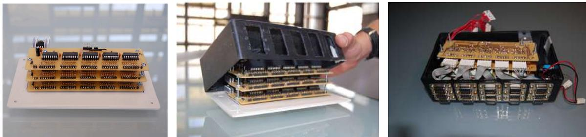
**Fig. 112:** Placas com os shift registers. Cada placa comanda 40 LEDs (uma das três cores de cada quatro linhas)
