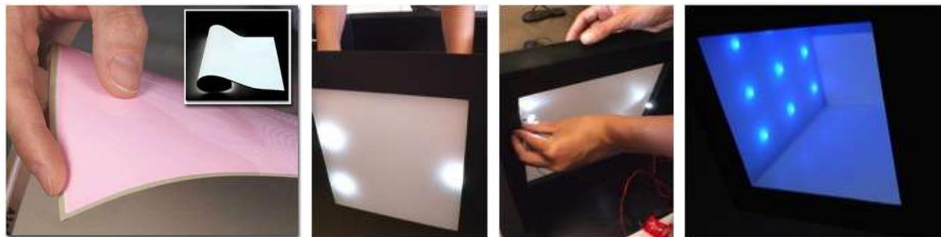
**Fig. 83:** Folha eletroluminescente: Como primeira opção de iluminação para a peça foram testadas folhas eletroluminescentes, uma opção interessante pelo efeito que proporciona e pelo baixo gasto de energia, porém seu uso foi descartado devido à dificuldade de aquisição e alto custo.
