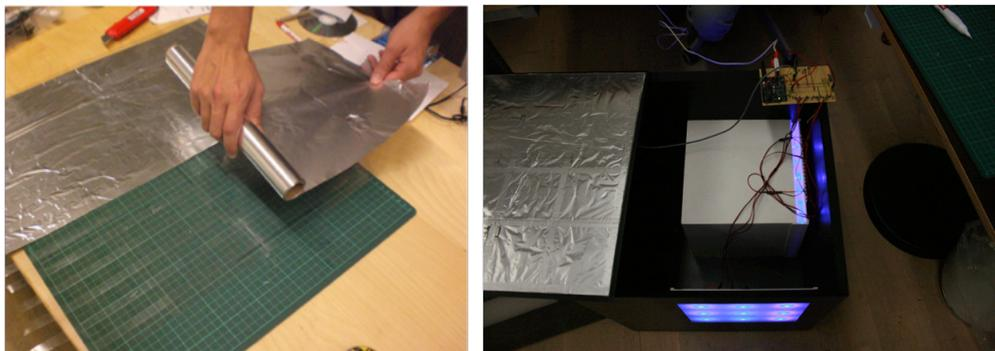
**Fig. 93:** Sensor de toque: o sensor de toque foi construído manualmente com duas superfícies de plástico nas quais foram fixadas camadas de papel alumínio (uma em cada parte), com espumas separadoras entre elas e disposto no tampo do objeto. Do meio do sensor sai um cabo que é conectado com o circuito central da peça. A imagem mostra a fixação do alumínio em uma das superfícies plásticas com a utilização de fita adesiva dupla face.
