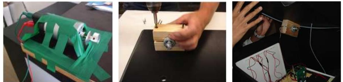
**Fig. 90:** Para a vibração foi utilizado um motor de alto giro no qual foi adicionado um peso que tira sua centralidade e causa a sensação de vibração. Esta é a mesma prática utilizada em telefones celulares quando colocados no “modo vibra”. No caso do projeto o motor foi utilizado tanto para vibração quanto como estímulo sonoro. A imagem mostra o motor fixado na mesa com fitas para teste.
