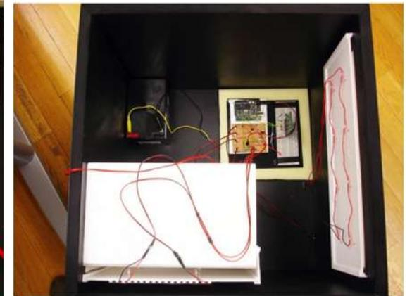
**Fig. 100:** Imagem da versão final do circuito, conectado com o Arduino e com o módulo transceiver.
