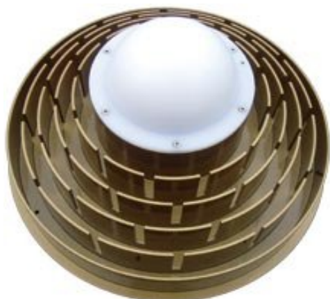
Figura 1 - Antena choke-ring - estrutura mecânica do modelo AR-25 Fonte: GPSWorld (2008)
