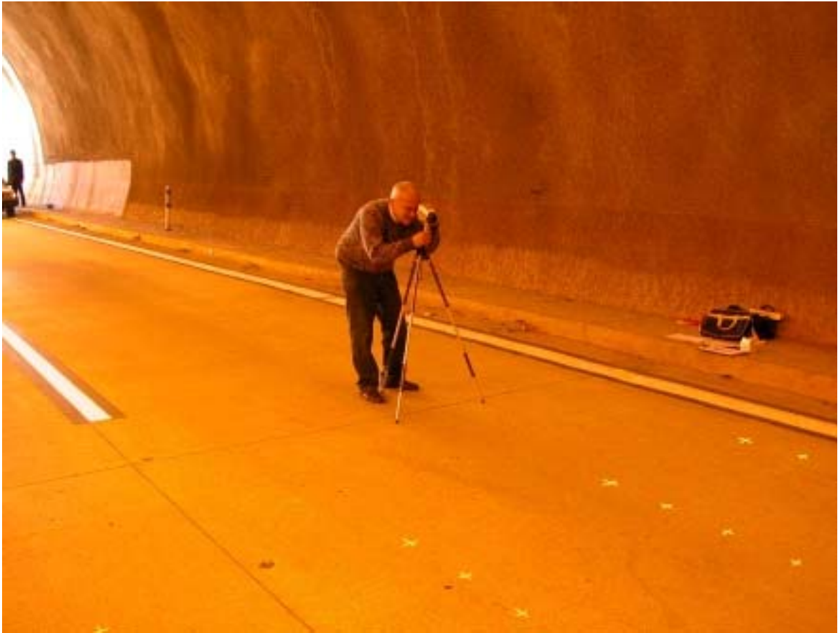
ILUSTRAÇÃO 114 – PR-1: Medição da Luminância do Pavimento (TE-2)
