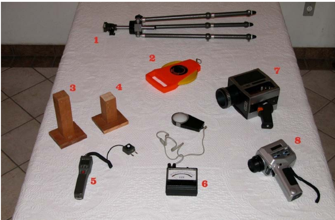
ILUSTRAÇÃO 109 – Equipamentos e Acessórios para as Medições nos Túneis
