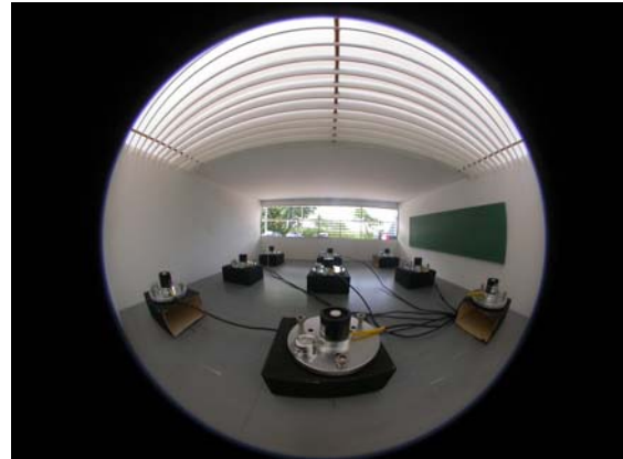
ILUSTRAÇÃO 43 - Modelo Físico de Sala de Aula Ensaio em Céu Real. Foto com Lente Hemisférica FONTE - BERTOLOTTI, 2007, p.40
