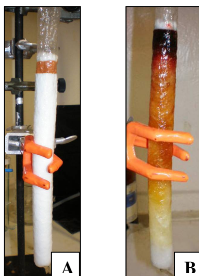
Figura 14 - Cromatografia em coluna seca da fração clorofórmica. Na figura A, a coluna pronta para ser eluída e na figura B, a mesma após a eluição
