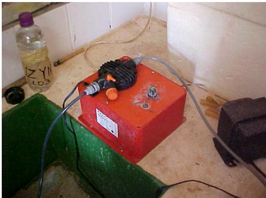
Figura 4.6. Bomba dosadora utilizada para alimentação dos reatores.
