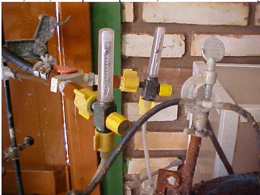
Figura 4.5. Detalhe do rotômetro de ar comprimido.
