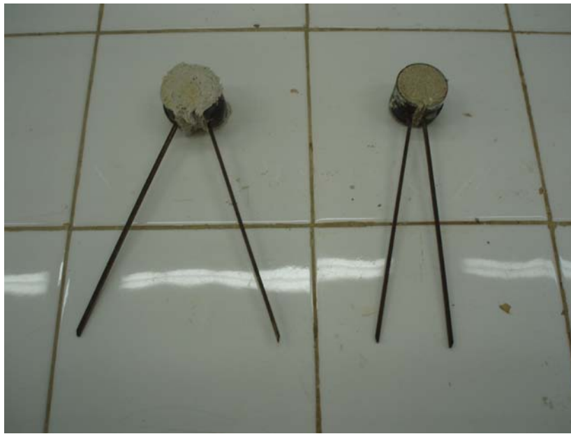
Figura 5.8. – Agulhas de Le Chatelier após 24 horas. À esquerda agulha com cimento expansivo, à direita agulha na proporção (cimento:areia) 1:3
