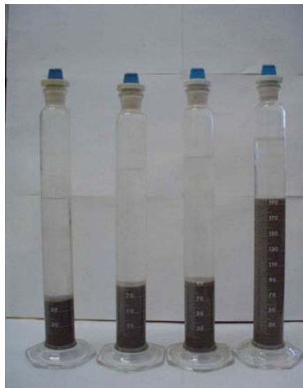
Figura 3.11. – Exemplo do ensaio de variação volumétrica X Tempo de mistura
