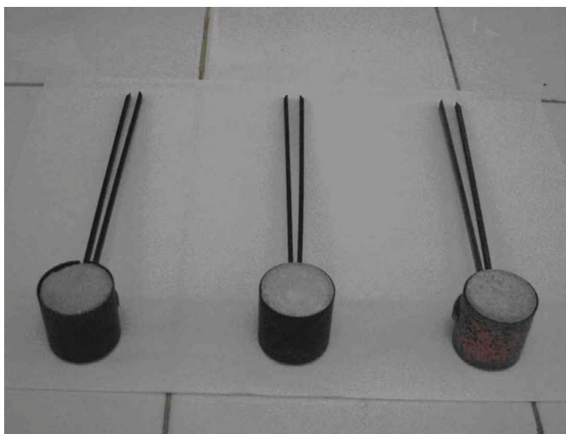
Figura 5.6. – Agulhas de Le Chatelier para sistemas com Ecat
