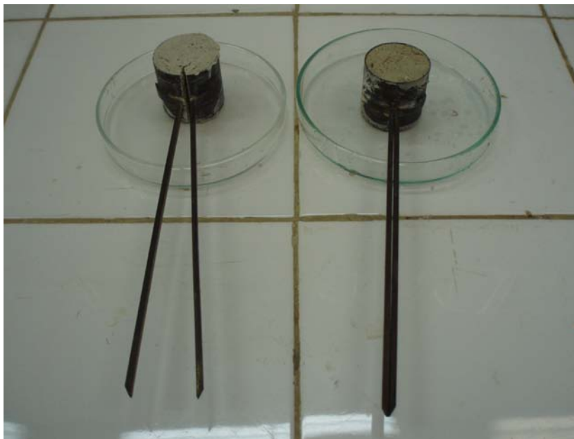
Figura 5.7. – Agulhas de Le Chatelier após 1 hora. À esquerda agulha com cimento expansivo, à direita agulha na proporção (cimento:areia) 1:3
