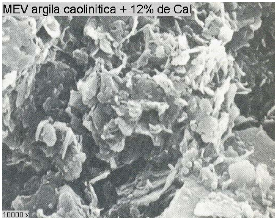
Figura 2.13. MEV da etringita formada pela reação de caolinita com o \text{Ca(OH)}_2 (CASANOVA, 1995)
