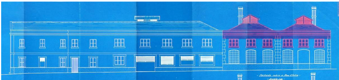
Fig. 60: Fachada da Rua Clélia. A autoria de Milton Ranzini, 1938. A parte assinalada refere-se à última etapa de verticalização do edifício, a qual contemplou a instalação de lanternins para a iluminação e ventilação da seção de vasilhames . O corpo maior, que também apresenta lanternim, é caracterizado pelo ritmo das aberturas existentes, entre as quais aquelas destinadas à entrada e à saída de matérias-primas e produtos acabados. Fonte: SÃO PAULO (Cidade) SMG-DAMP, Processo 66.005/1938.
