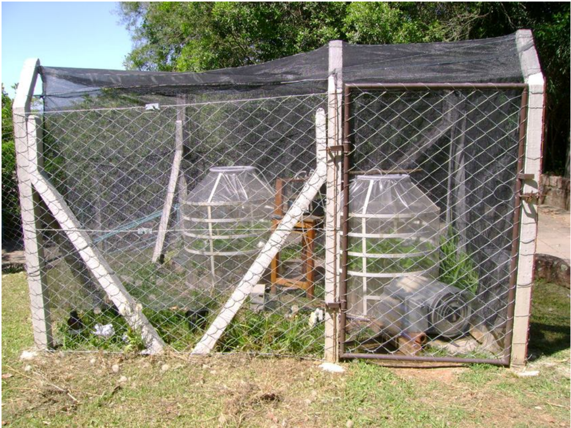
Figura 1B: Local e estrutura onde foram mantidas as câmaras de topo-aberto. Observar o revestimento feito com sombrite.
