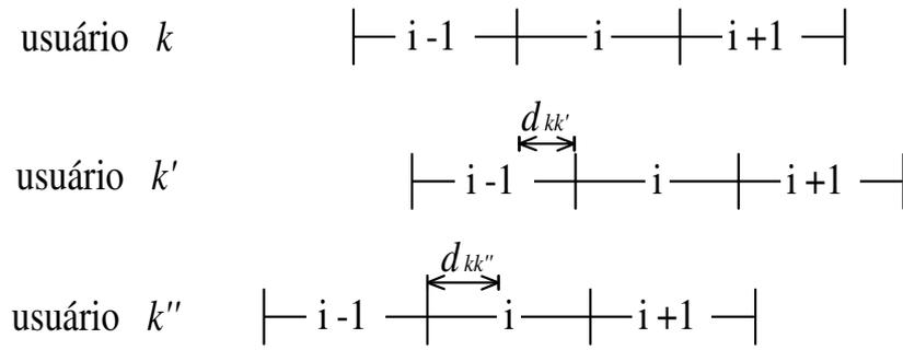
**Figura 4.2:** Modelo DS/CDMA assíncrono para controle de potência.
