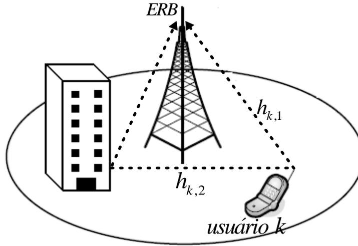
**Figura 4.1:** Canal de multipercursos para controle de potência.
