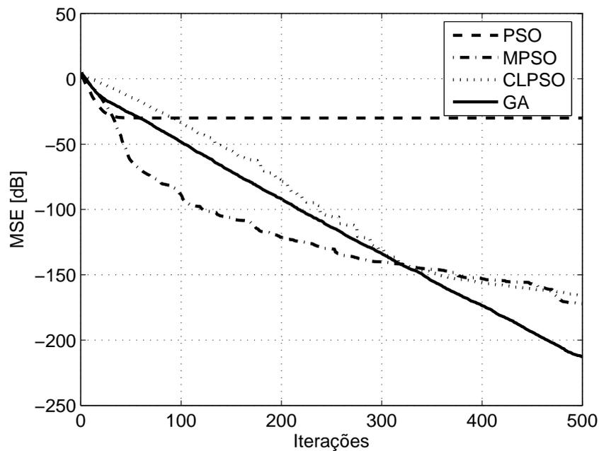
**Figura 5.4:** Curva de convergência dos algoritmos heurísticos para o sistema com superfície de erro unimodal, Sistema I, para  $P = 20$ .
