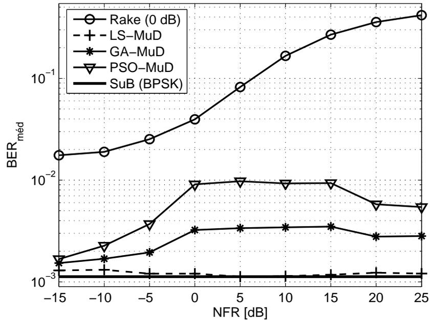
**Figura 3.7:** *BER* para os HEUR-MUD, considerando idêntica complexidade computacional para os três algoritmos estudados e igual àquela necessária à convergência do LS-MUD, para  $E_b/N_0 = 15dB$ ,  $K = 10$ ,  $I = 7$ ,  $D = L = 2$  e  $N = 31$ .
