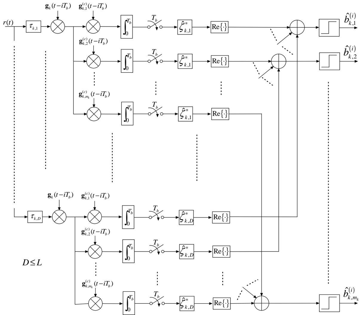
Figura 3.2: Recepção para sistema DS/CDMA multitaxa, com  $D \leq L$ .
