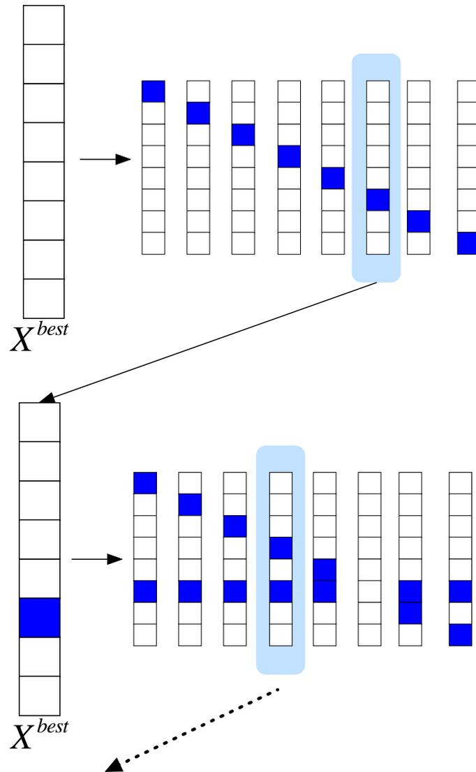
**Figura 2.6:** Diagrama simplificado de funcionamento do algoritmo LS 1-ótimo.
