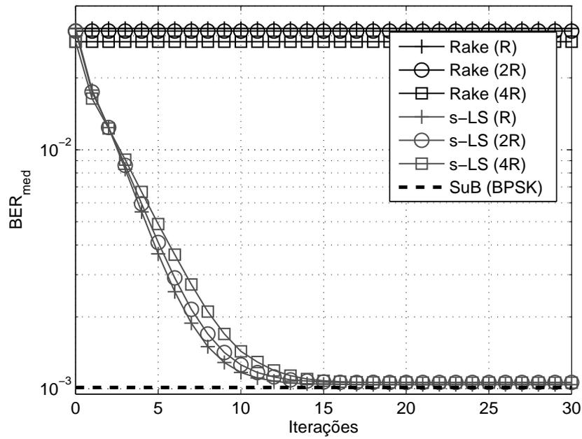
**Figura 3.14:** Simulação para sistemas multitaxa, com taxas de  $R$ ,  $2R$  e  $4R$ ,  $M = \frac{K}{N} = 0,75$  ( $K_v = 24$ ),  $E_b/N_0 = 10dB$ ,  $D = L = 2$  e  $I = 7$ .
