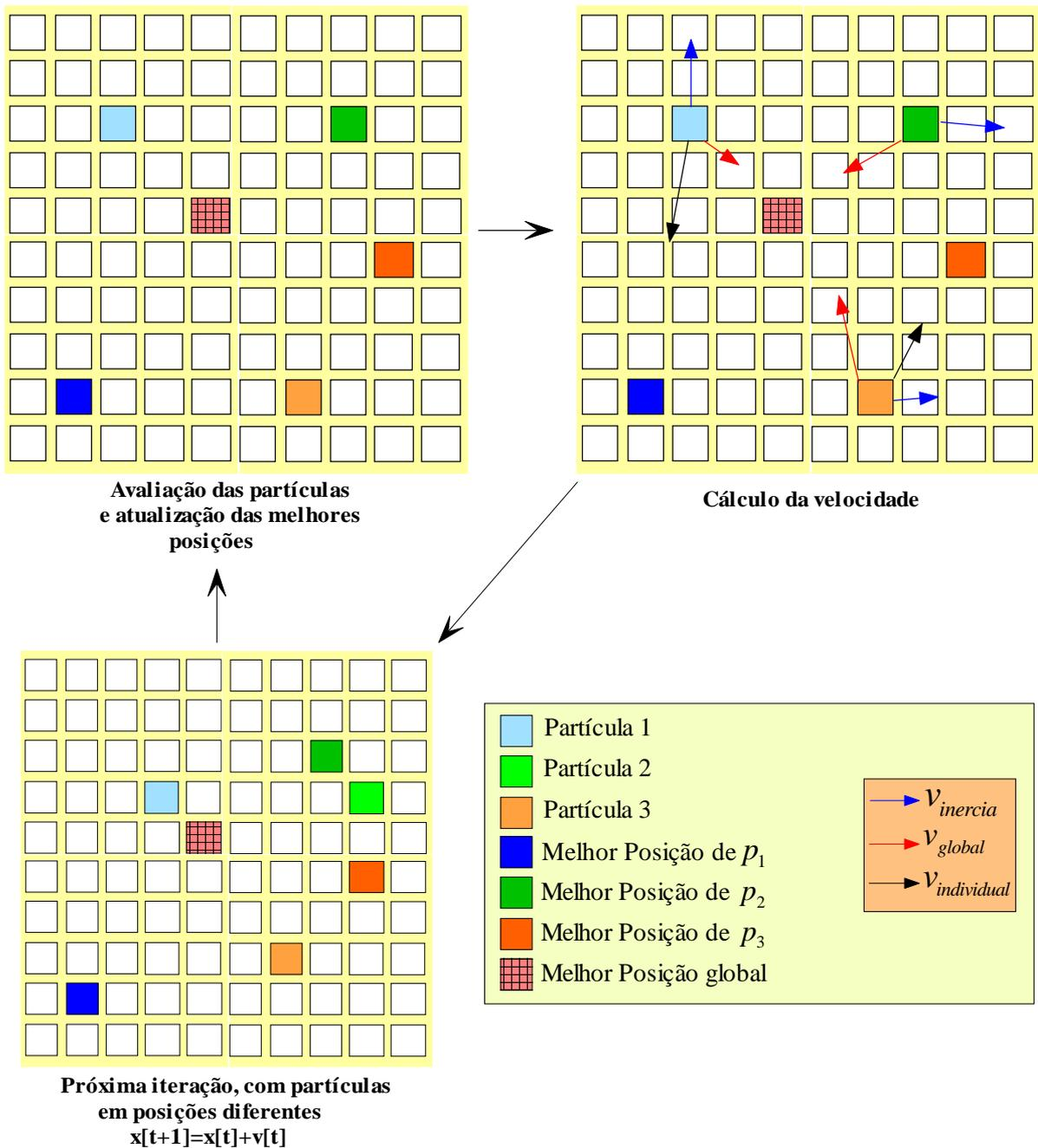
**Figura 2.3:** Diagrama simplificado de funcionamento do algoritmo PSO.
