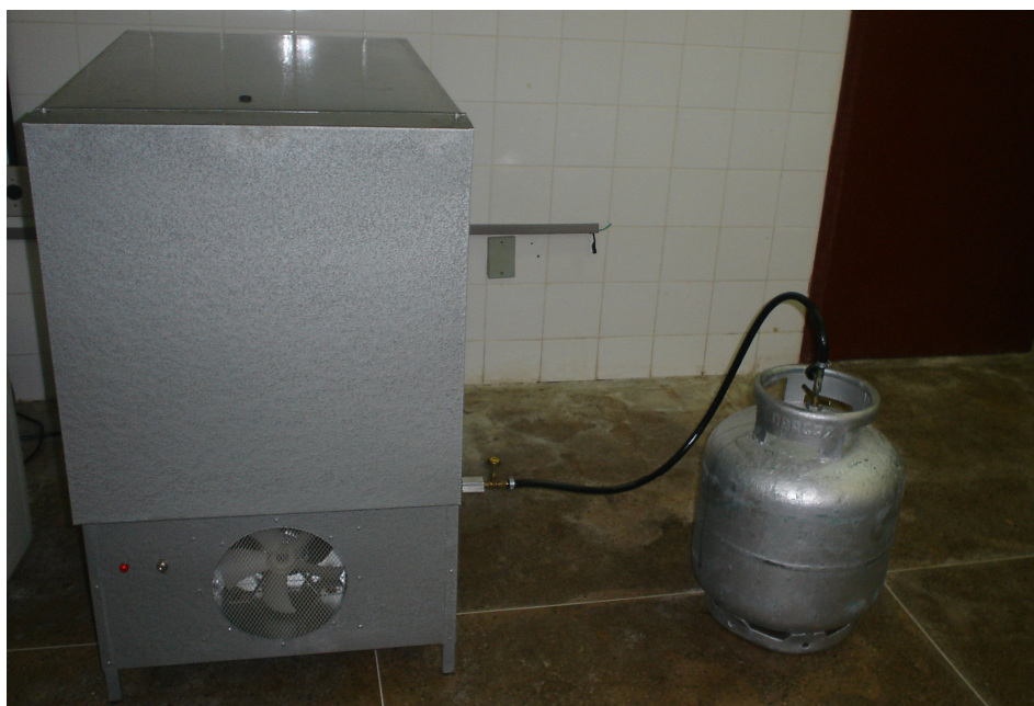
Figura 4. Secador de bandejas Polidryer PD-25
