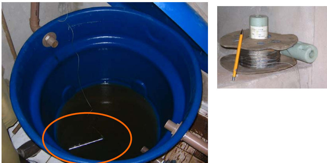
Figura 4.22 - Monitoramento das águas que escoam do telhado verde utilizando o CTD-Diver © .
