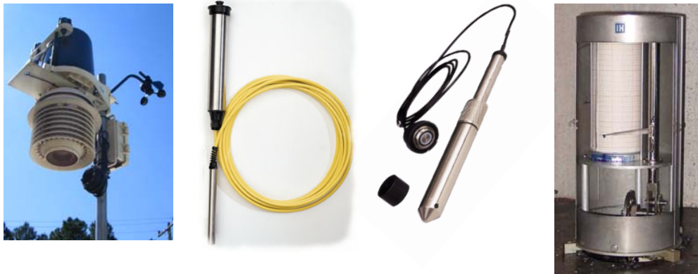
Figura 4.16 - Equipamentos de medição utilizados para o monitoramento do lote urbano: estação meteorológica e linígrafos automáticos e de bóia.
