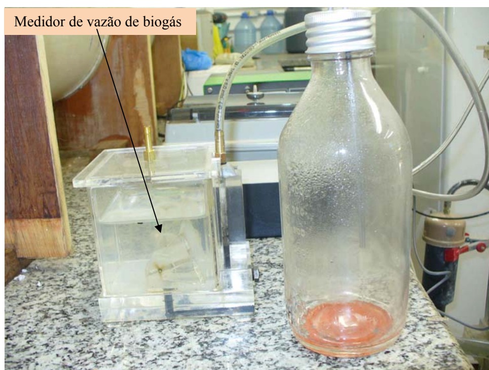
FIGURA 4.7 - Medidor de vazão de biogás.
