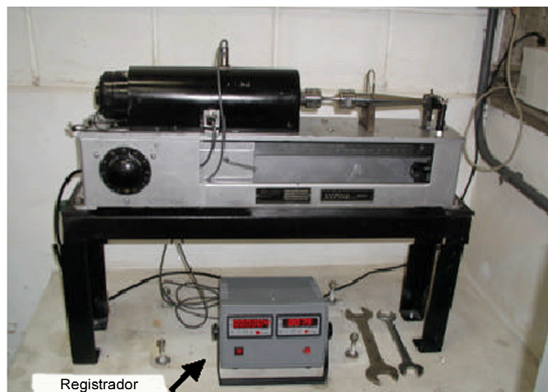
Figura 32 - Máquina de fadiga por flexão rotativa da Fatigue Dynamics modelo RFB-200. Vista geral do equipamento.
