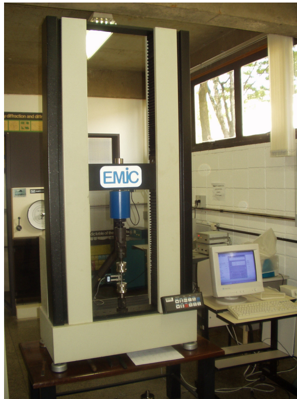
Figura 31 - Máquina de ensaio de tração, EMIC, programada por computador.
