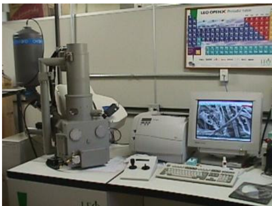
Figura 27 - Microscópio Eletrônico de Varredura Zeiss-Leica 440, do Instituto de Química de São Carlos (IQSC – USP).
