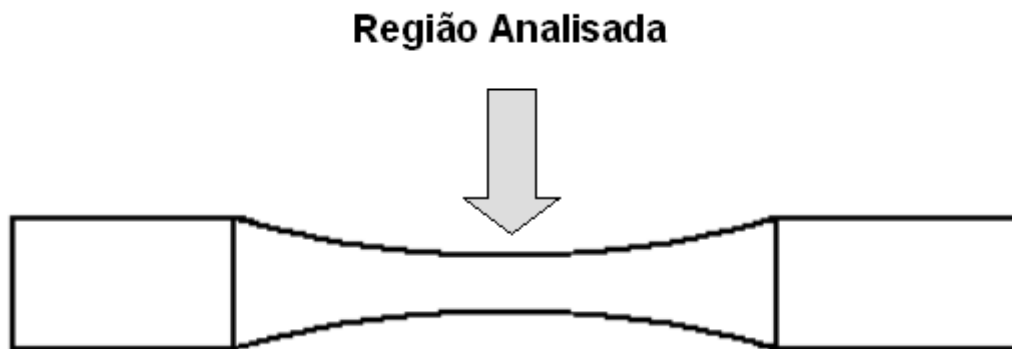
Figura 28 - Ilustração do corpo de prova e a região a qual foram realizadas as análises de deformação residual.
