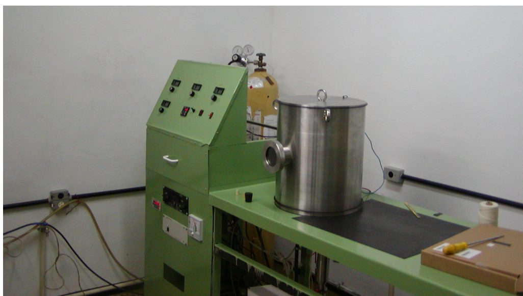
Figura 26 - Fotografia do equipamento de nitretação iônica do Departamento de Física da UFSCar, usado nos experimentos.
