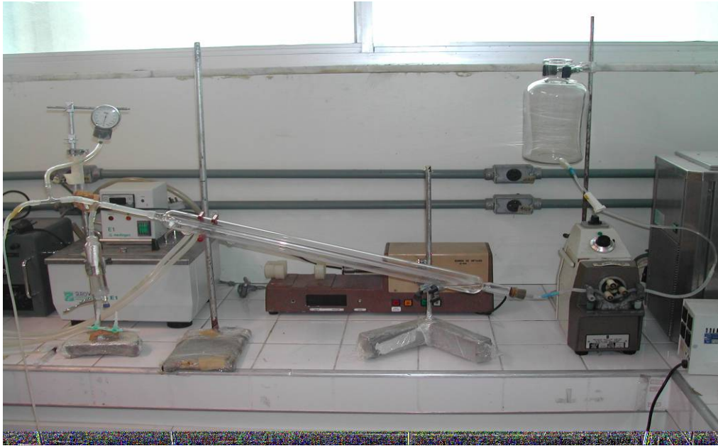
Figura 10: Foto do sistema de perfusão de leito vascular mesentérico.
