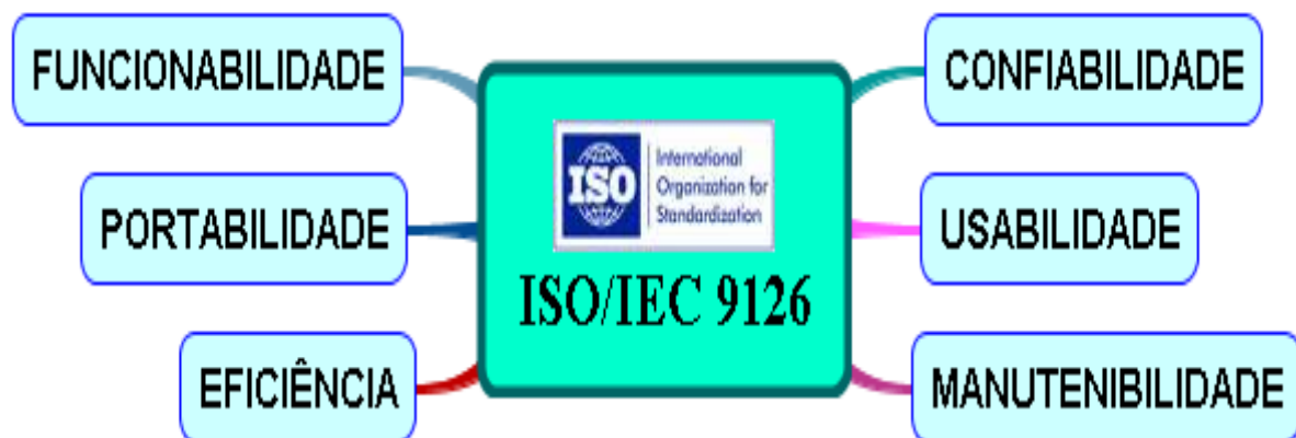
Figura 04 – As qualidades internas e externas da NBR ISO/IEC 9126-1:2003
