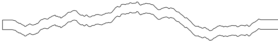
Figura 2: Perfil de uma estrutura rugosa auto-afim com comprimento L/\delta = 256 e expoente de Hurst \zeta = 0.8 . O canal auto-afim bidimensional possui simetria de eixos paralelos em relação à direção média de escoamento.
