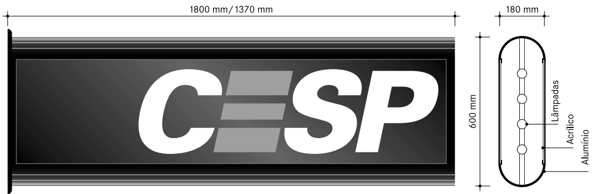
SISTEMA DE IDENTIFICAÇÃO EXTERNA DE INSTALAÇÕES, 1977. DIMENSÕES DO LUMINOSO – VISTA FRONTAL (GRAFEMA VERMELHO) E CORTE ESQUEMÁTICO.
