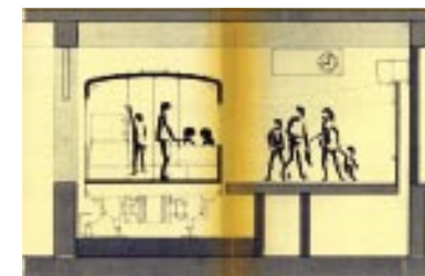
CORTE ESQUEMÁTICO. RELAÇÃO ENTRE O ÂNGULO VISUAL DO PASSAGEIRO E O CONJUNTO INFORMATIVO DA PLATAFORMA (FAIXA CONTÍNUA DE INFORMAÇÕES, PAINEL DE REVESTIMENTO, QUADRO INFORMATIVO, INDICADOR DE TREM/RELÓGIO E PAINEL DE PROPAGANDA SUSPENSO).
