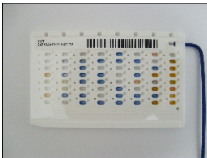
Figura 15. Cartão para identificação de leveduras pelo sistema VITEK 2.
