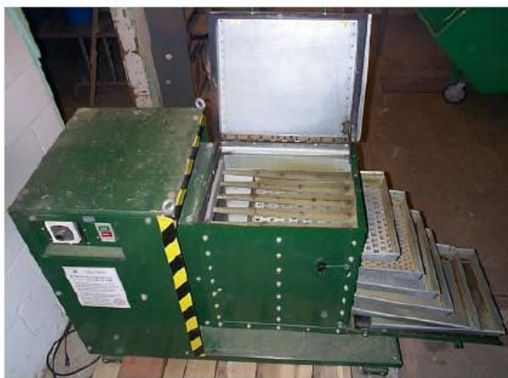
Figura 1 – Separador de fragmentos (ASAE S424). Adaptado de ZHANG (2002)
