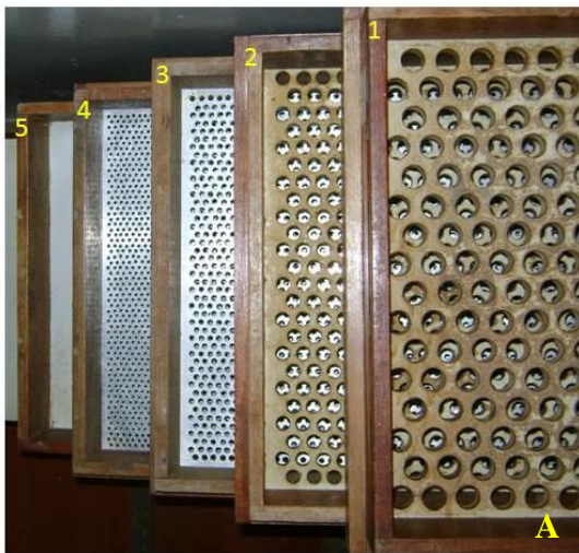
Figura 5- Peneiras utilizadas para a determinação do tamanho de fragmento no ensaio (A). Agitador e posição das peneiras (B)
