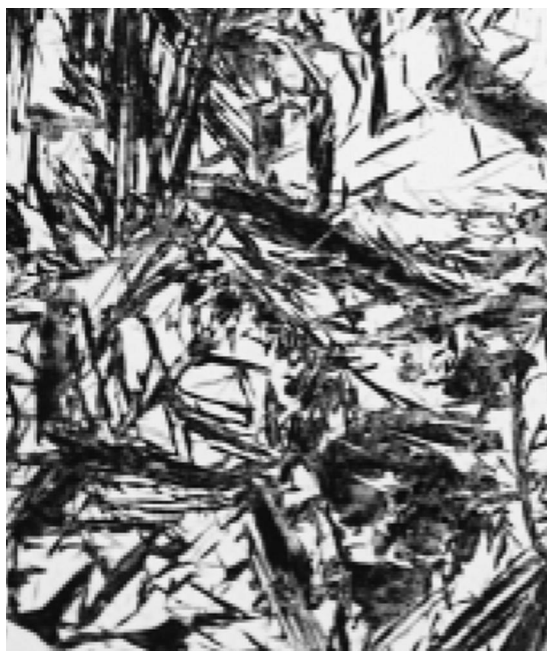
Figura 1 – Fotomicrografia ilustrando a estrutura martensítica (agulhas escuras) e austenita retida (parte clara), (Callister, 2002).
