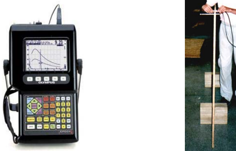
Figura 17: (a) Equipamento de ultra-som PANAMETRICS, modelo EPOCH4 e (b) esquema para medição do tempo de propagação de onda através da espessura dos painéis através do equipamento PANAMETRICS, modelo EPOCH4.
