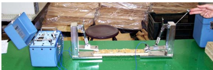
Figura 16 – Exemplo de posicionamento dos transdutores do aparelho stress wave para a medição do tempo no painel OSB e nos corpos-de-prova.
