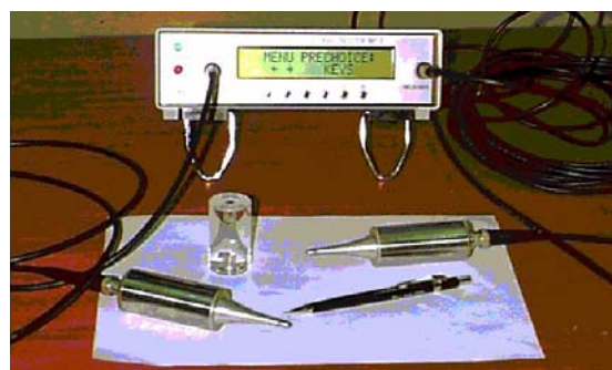
Figura 11 – Equipamento de ultra-som STEINKAMP, modelo BP-7.
