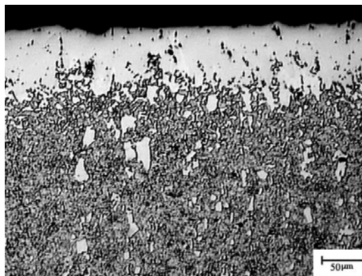
Figura 4.22 - Micrografia ótica mostrando a camada formada sobre o aço AISI D2, tratado no banho 10%Fe-Ti + 5%Al, 1000°C/4h. Camada de borretos sobre o substrato martensítico. Ataque: Reagente de Vilella.
