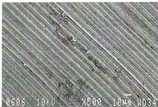
Figura 2.11 - Superfície de desgaste típica para o modo de abrasão a dois corpos. Observa-se a presença de riscos paralelos [Trezona et al. , 1999].
