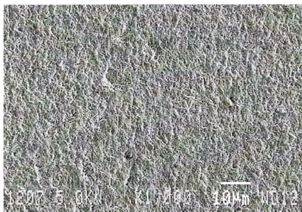
Figura 2.12 - Superfície de desgaste típica do modo de abrasão a três corpos [Trezona et al. , 1999].
