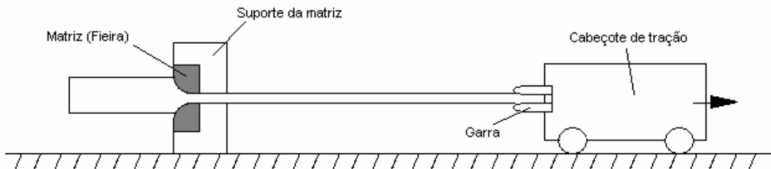
Figura 12: Desenho esquemático de uma bancada de trefilação [45] .
