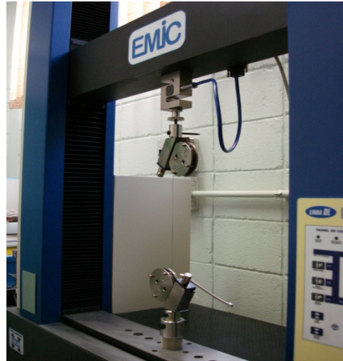
Figura 3: Fotografia mostrando a garra caracol, utilizada para fixação do fio durante os ensaios de tração.
