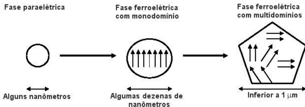
Figura 12 - Descrição esquemática do efeito do tamanho de grão na estrutura de domínio ferroelétrica [26].
