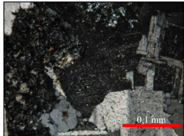
Figura 39: Fotomicrografia de cristal reliquiar de K-feldspato bastante sericitizado. (10X-LT, NC).
