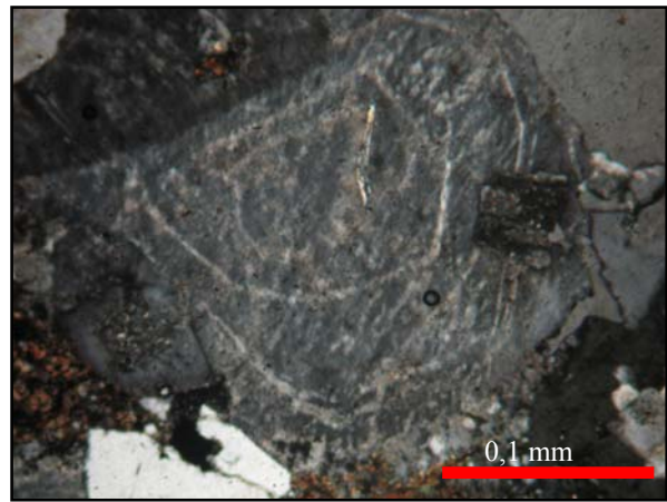
Figura 18: Fotomicrografia Feldspato potássico pertítico com zoneamento de composição albitica (10X-LT, NP).
