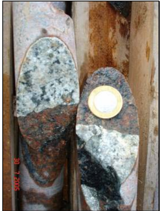
Figura 15: Foto de testemunho de sondagem com vênulas de carbonato em fraturas no granito Palito.
