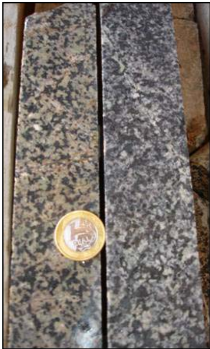
Figura 6: Foto de testemunho de sondagem do granodiorito Fofquinha com magnetita.
