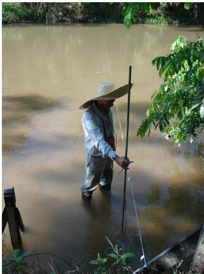
Figura 4.8 – Medição de vazão à vau no Rio Taquarizinho, na seção da ANA (exutória da área de drenagem).
