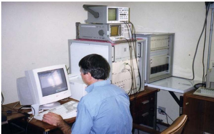
FIGURA 3.11 - Sistema físico do radar. Composto de uma unidade de controle (Receptores, transmissor e computador), em Cachoeira Paulista - SP.
