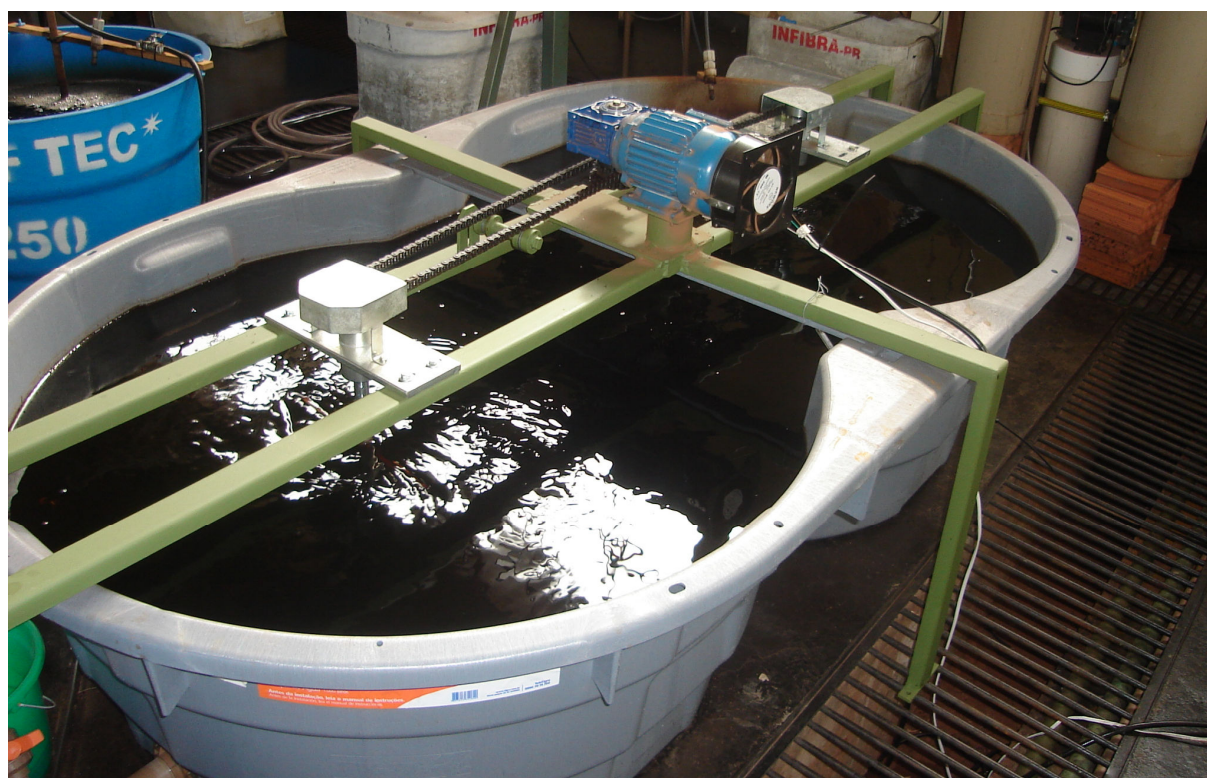
Tanque de stripping (1.000L).
