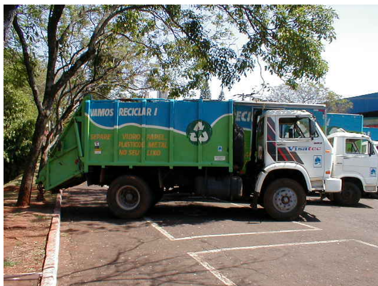
Figura 17 – Caminhão compactador do setor público destinado ao transporte de rejeitos
