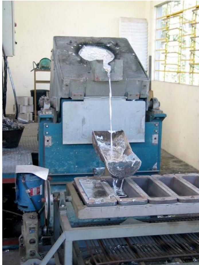
**Figura 13 – Lingotamento do metal líquido**
