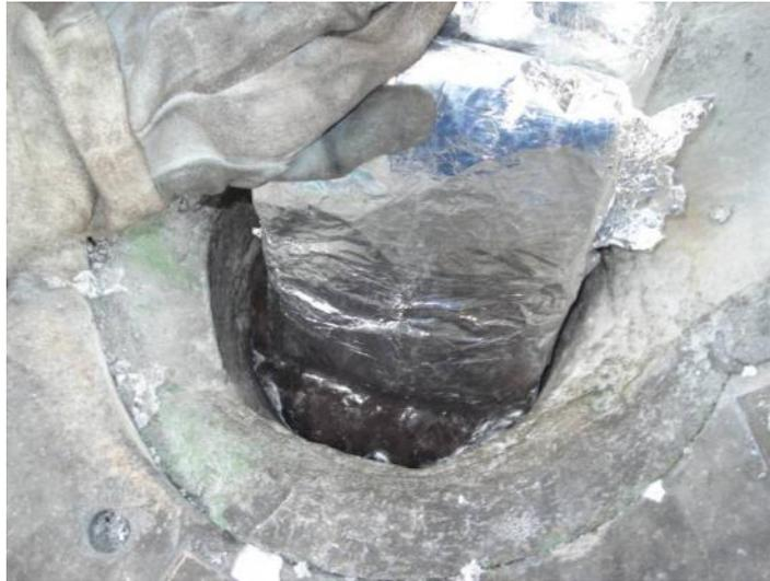
**Figura 9 – Procedimento de alimentação do forno de fusão**
