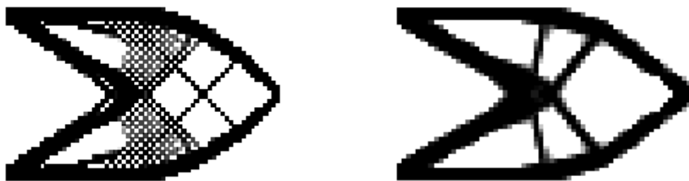
Figura 4.2 - Exemplo de um projeto ótimo alcançado via otimização topológica: (a) presença do fenômeno de checkerboard na solução; (b) problema regularizado, sem o checkerboard .
