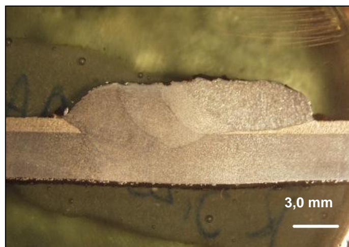
Figura 4.57- Ausência de poros e fusão completa do revestimento em cordões de solda depositados com procedimento de 'meio desbaste'.
