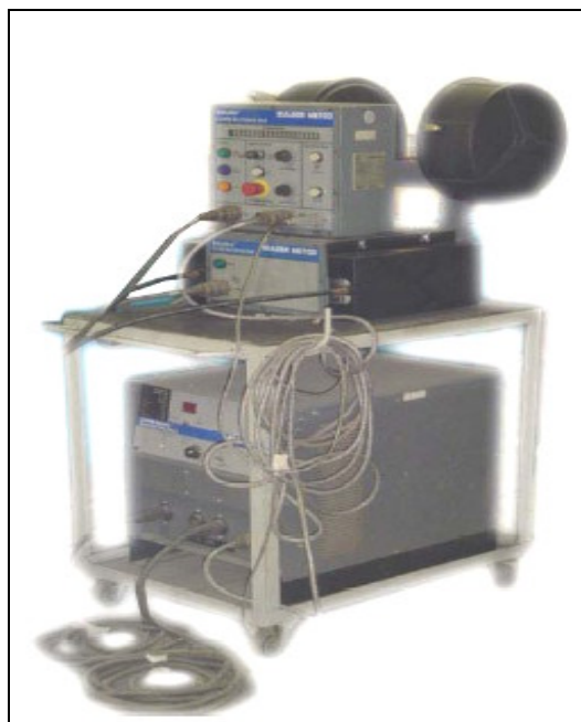
Figura 3.1- Fonte Sulzer Metco ValueArc 300E onde foram preparadas as amostras por AS.
