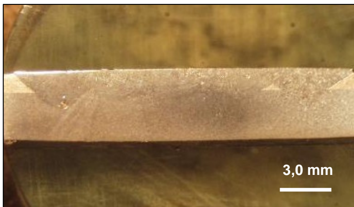
Figura 4.64- Deposição da primeira camada de solda pelo procedimento de desbaste total dos cordões.
