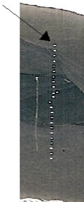
Figura 4.93- Medidas de microdureza HV0,30 após deposição de solda com energia de 6,5 kJ/cm sobre corpo de prova revestido com 0,8 mm e pressurizado a 5,0 MPa.
