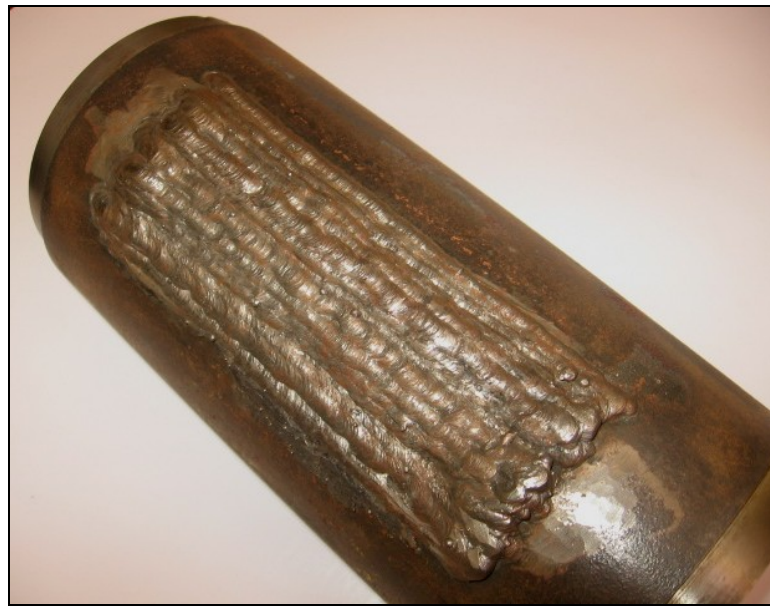
Figura 4.81- Corpo de prova com total preenchimento com solda na região de dano simulado.
