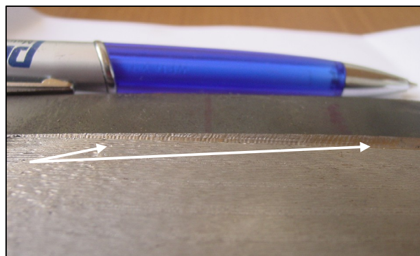
Figura 4.36- Redução gradual por usinagem da espessura da chapa.
