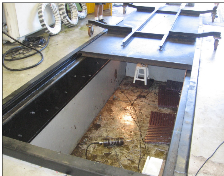
Figura 4.85- Corpo de prova a ser ensaiado dentro de bunker subterrâneo.
