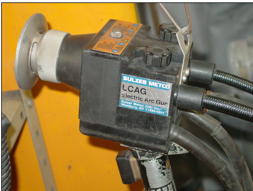
Figura 2.34– Pistola para aspersão térmica a arco elétrico do Laboratório de Aspersão Térmica e Soldagens Especiais da UFPR.
