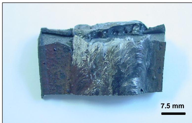
Figura 4.55- Fratura, após dobramento, em cordões de solda provocados pela incompleta fusão do revestimento aspergido.
