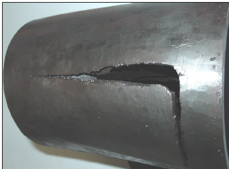
Figura 4.89- Desenvolvimento da trinca ao longo da ZTA em ensaio de ruptura de corpo de prova RP com deposição de solda sobre revestimento aspergido com 0,8 mm de espessura.
