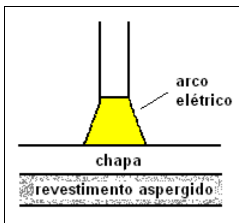
Figura 4.35- Configuração para deposição de solda em material maciço sobre revestimento aspergido.
