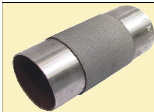
Figura 4.65- Corpo de prova de tubo API 5LX-70 com diâmetro de 100 mm e espessura reduzida de 3,0 mm. A amostra é revestida em 120 mm na parte central.
