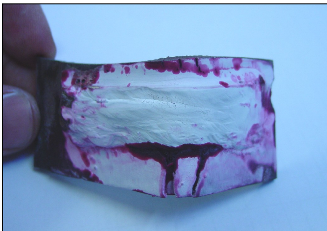
Figura 5.58- Inspeção por Líquidos Penetrantes comprova ausência de trincas após dobramento em cordões de solda com completa fusão do revestimento aspergido.
