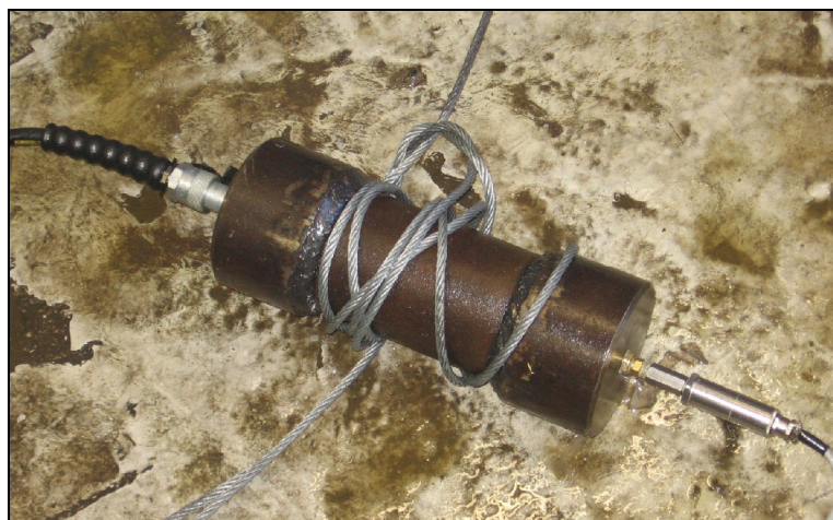
Figura 4.84- Corpo de prova com tampões e acoplamentos para entrada e saída do óleo.
