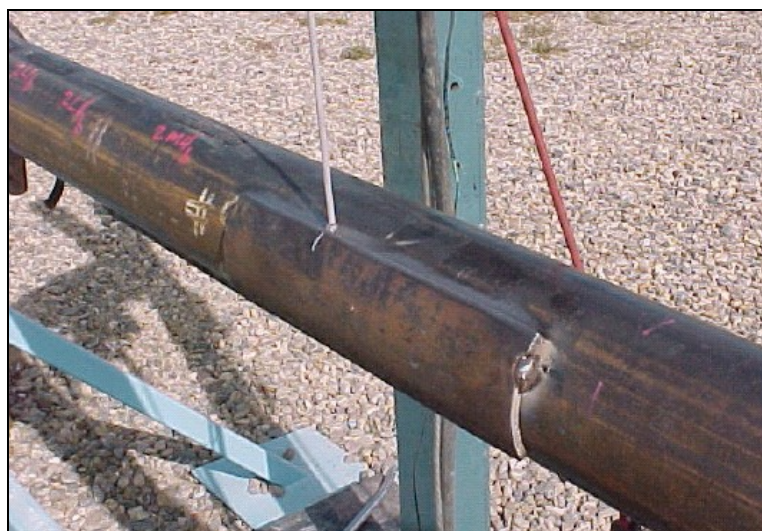
Figura 2.4– Solda de filete entre tubo e calha [2].
