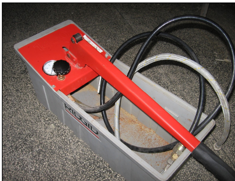
Figura 3.10- Bomba para teste hidrostático utilizada na pressurização dos tubos.
