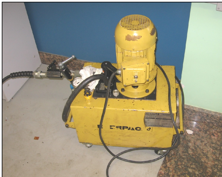
Figura 3.15- Bomba utilizada para pressurização do óleo nos ensaios de pressurização.
