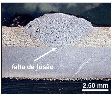
Figura 4.29- Falta de fusão do revestimento em cordão de solda depositado com 70 A de corrente sobre espessura aspergida de 1,92 mm.
