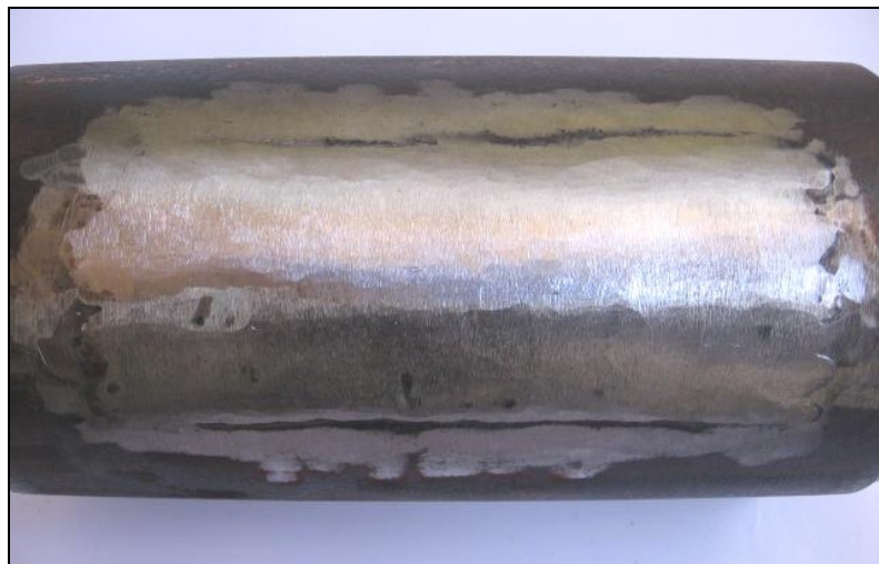
Figura 4.82- Corpo de prova com retirada por esmerilhamento do reforço de solda.
