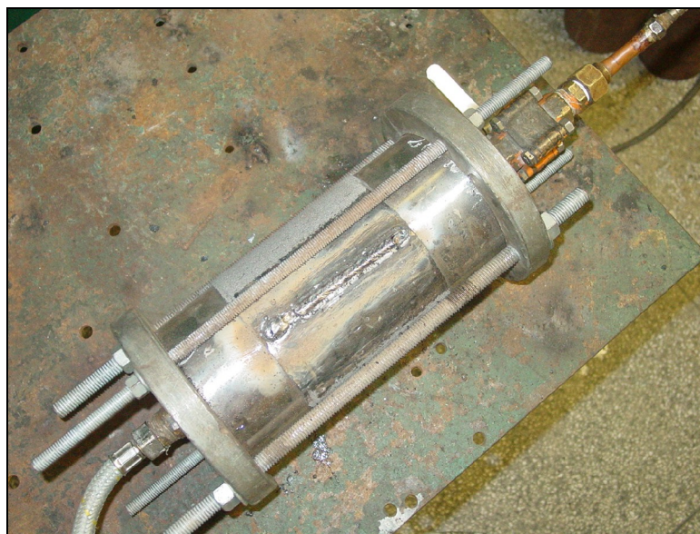
Figura 4.68- Corpo de prova de tubo já montado com flanges e mangueiras pronta para pressurização ou escoamento de água.
