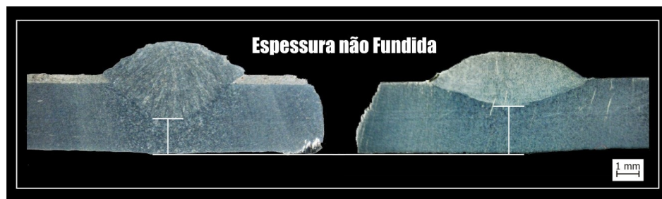
Figura 4.21- Maior risco de perfuração na região revestida por aspersão térmica com espessura da camada dentro da faixa crítica.
