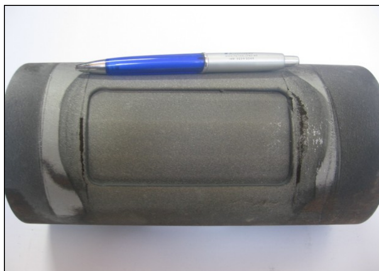
Figura 4.75- Corpo de prova com espessura parcialmente recuperada em 0,8 mm por processo FS.
