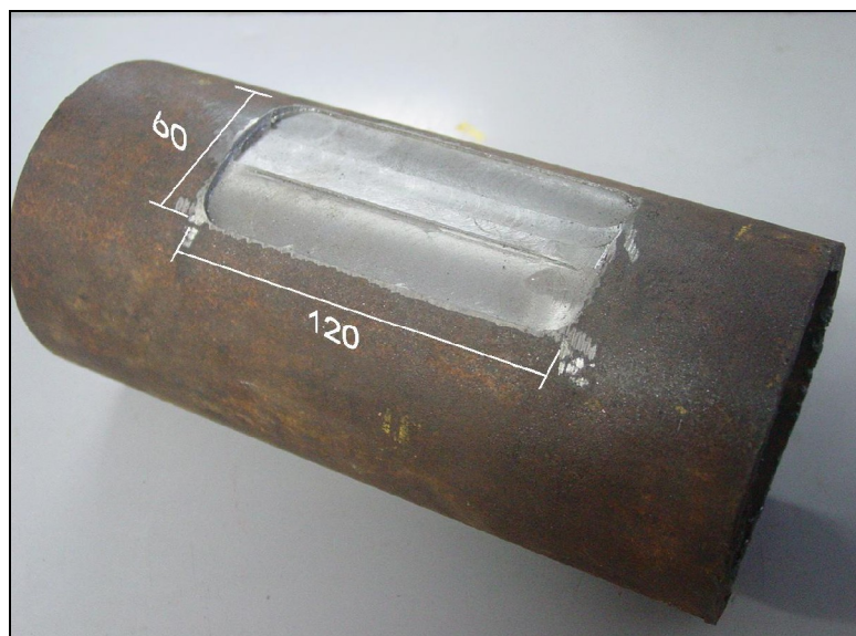
Figura 4.73- Corpo de prova com área para reparo efetuada por usinagem (medidas em mm).
