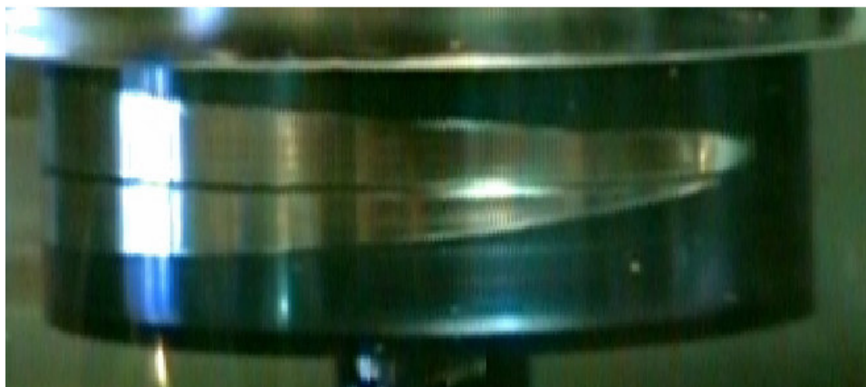
Figura 2-3 – Visualização da região de cavitação em mancais radiais planos. (San Andrés, 1998).
