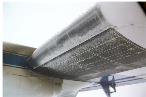
Figura 1.3: formação de gelo durante ensaio de voo (NASA Lewis [67]).
