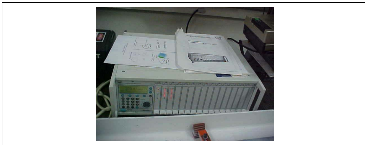
Figura 5.9 Sistema de medição de deformação dos extensômetros instalados nos corpos de prova.
