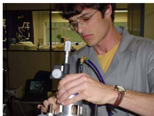
Figura E.2 Módulo de Medição de Tensões Residuais Labmetro / UFSC - Detalhe do módulo de furação.
