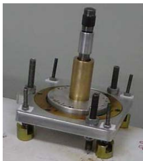
(b) sistema de indentação sobre a base universal do medidor de tensões residuais.
