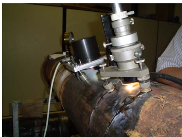
Figura E.9 Vista do sistema de medição óptico (MTRES Modular) e o sistema de medição por "strain gages" (RS200)
