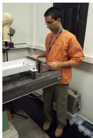
Figura E.11 Sistema de simulação de tensões residuais. Detalhe da aplicação de carga no corpo de prova
