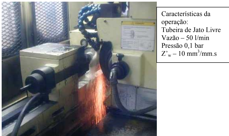
Figura 2.35 – Alimentação de fluido de corte com jato livre com pressão 0,1 bar (Weingärtner, 2005).
