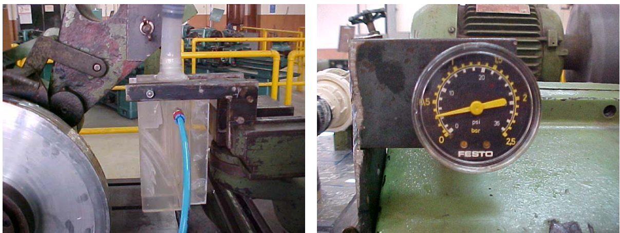
Figura 3.13 – Manômetro para medição da pressão interna da tubeira.
