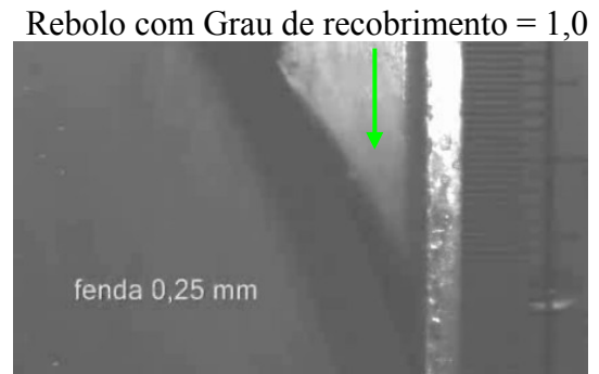
d) Comportamento do fluido no interior da tubeira A de canal simples para velocidade de 100 m/s, vazão 10 l/min e abertura da fenda rebolo/tubeira 0,25 mm
