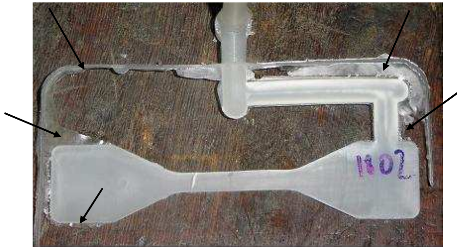
figura 7.1. Rebarbas nos moldados em epóxi (parede espessa).
