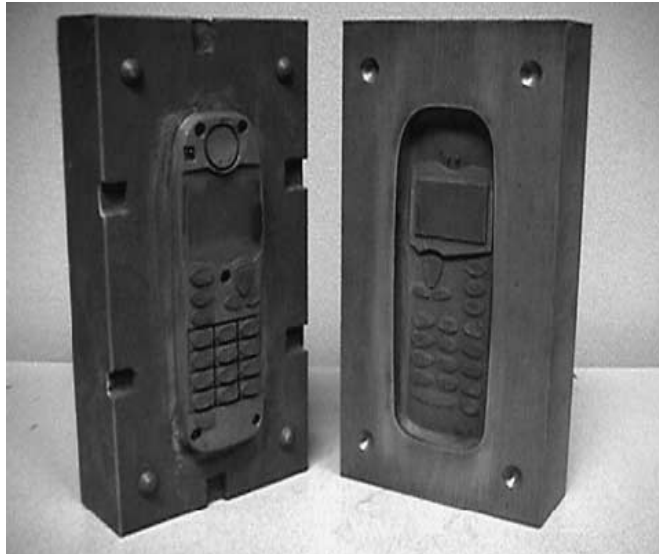
figura 4.3. Insertos VRE para injeção de tampa frontal de telefone celular. [Adaptado de CHEAH (2002)].
